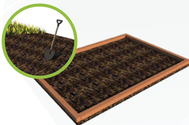
Se prepara el terreno removiendo la capa vegetal superficial y extrayendo entre 6 a 8 cm de tierra para sustituirla por una sub-base adecuada. Luego, se confina el área con bordes para evitar la erosión de los materiales.
