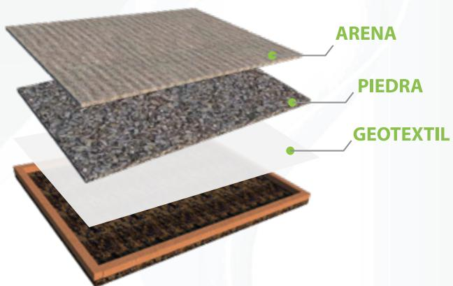
El terreno se rellena con un 50% de piedra y un 50% de arena, utilizando como base una capa de geotextil cuya función es prevenir el crecimiento de maleza. Posteriormente, se realiza un proceso de compactación mecánica para obtener una superficie uniforme.
