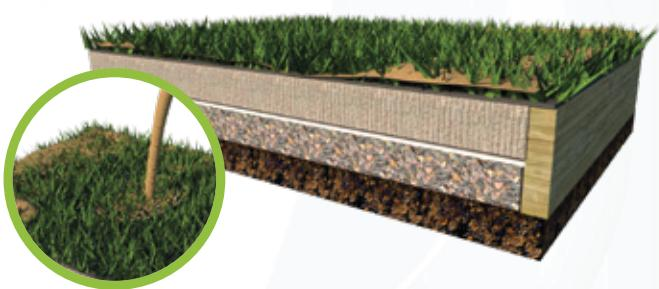
Una vez lista la superficie y ya instalado el césped, este se rellena con arena sílica con el objetivo de mantener las hebras erguidas, conservar la humedad y generar una sensación agradable al caminar.
